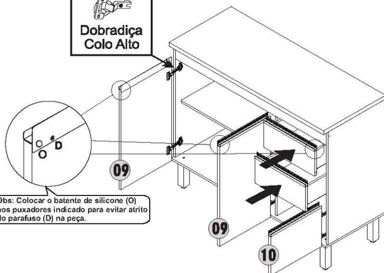
Obs: Colocar o batente de silicone (O) nos puxadores indicado para evitar atrito do parafuso (D) na peça.
