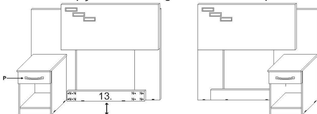
A peça nº 13 só deve ser colocada após fixação do criado.
